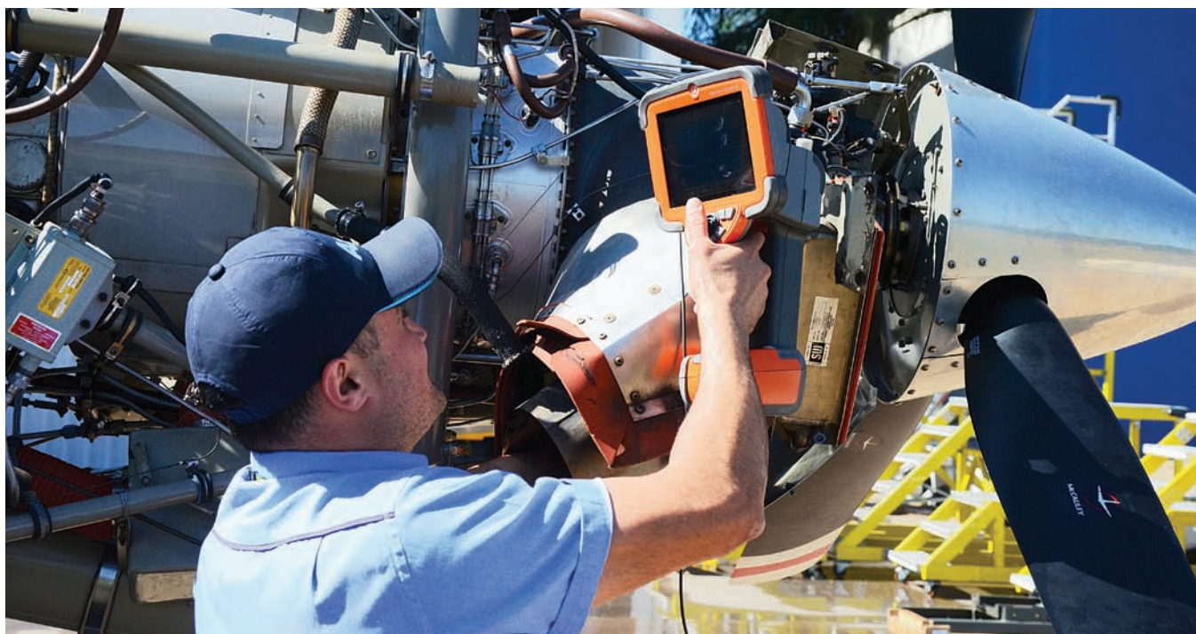
Câmera boroscópica permite o diagnóstico das peças sem a necessidade de desmontar o motor
